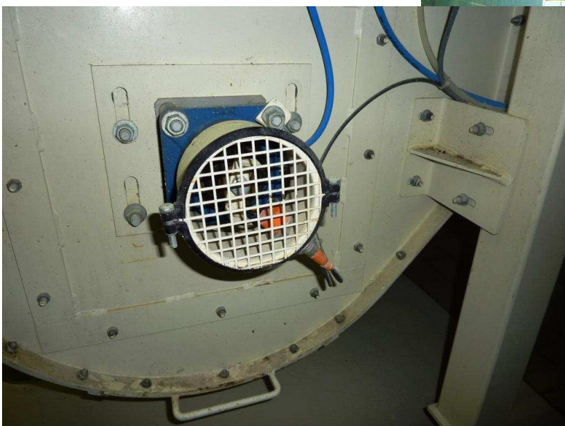
Photo 8 (à gauche) : contrôle de rotation sur pied d'élévateur arrondi (afin d'éviter la rétention de produit)
